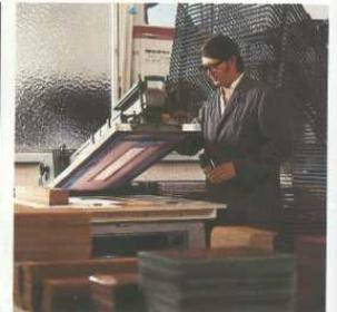
3: Das Ausgangs-Material der Platinen wird in der werkeigenen Siebdruckerei bedruckt.
