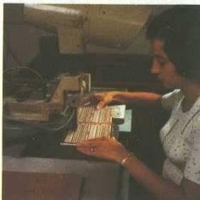
7: Hochgeschwindigkeits-Bohrmaschinen bohren Löcher in die fertigen Platinen. Durch diese stecken Sie später die einzelnen Bauteile.
