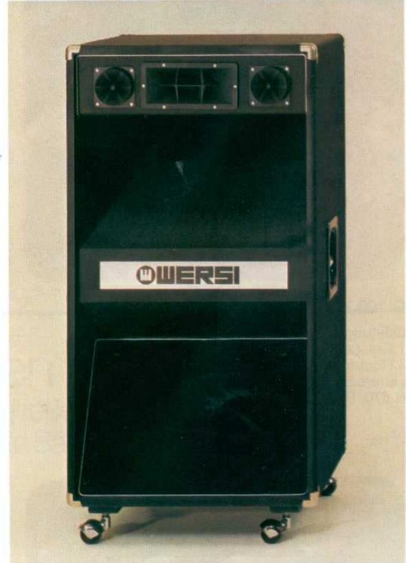
Diese professionellen Hochleistungsboxen nach dem Exponentialprinzip arbeiten mit zwei zuschaltbaren piezokeramischen Hochtönern und einem ebenfalls zuschaltbaren Druckkammerlautsprecher mit Exponentialhorn.
