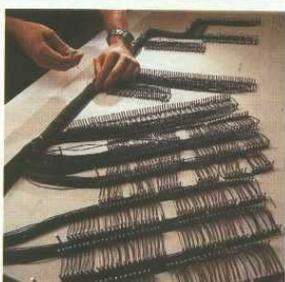
8: Diese von WERSI vorgefertigten Kabelbäume ermöglichen den problemlosen Aufbau der Orgel. Sie verbinden die einzelnen Baugruppen.
