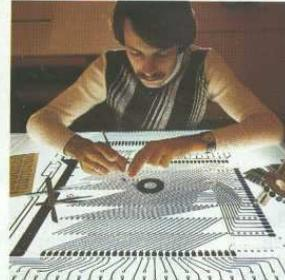
2: Die einzelnen Leiterbahnen der Schaltung werden geklebt. Später wird sie als gedruckte Platine dem Kunden geliefert.
